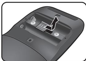
b) Sbloccare il fermo del vano batterie.
